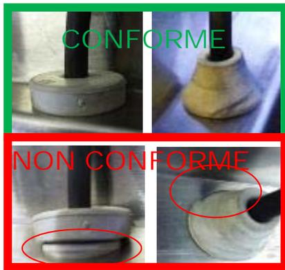
Figure 18 – Vérification du positionnement du passe-câble étanche
